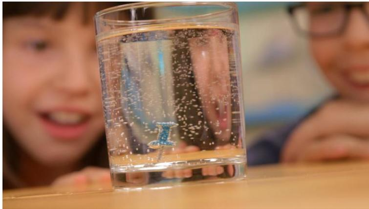
4.) Die Gasbläschen setzen sich an der Nadel fest. Wenn es immer mehr und mehr werden, dann richten sie die Nadel auf und am Ende steigt die Nadel sogar auf.
